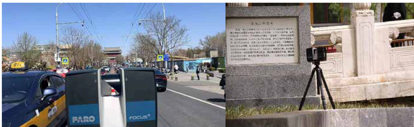
图五 三维激光扫描现场
