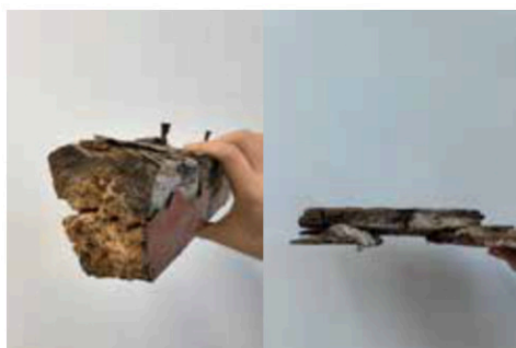
图一三 团河行宫拆除的椽子及望板，越靠下的部分糟朽越严重
