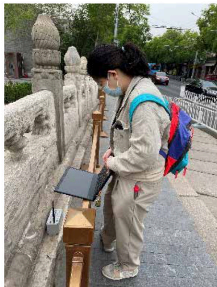
图八 振动特性采集现场
