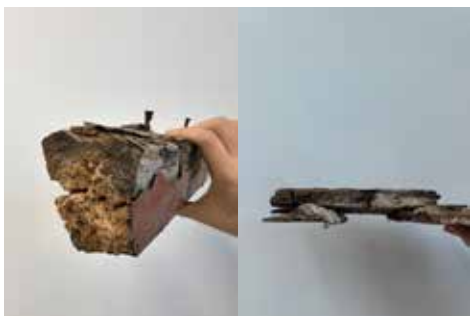
图一三 团河行宫拆除的椽子及望板，越靠下的部分糟朽越严重
