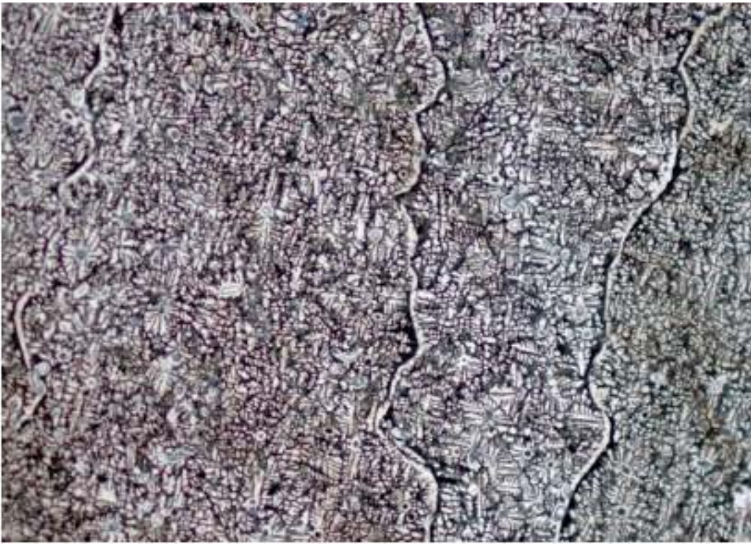
图八 TJ08金相照片-1 C型组织，锡含量：32.5%
