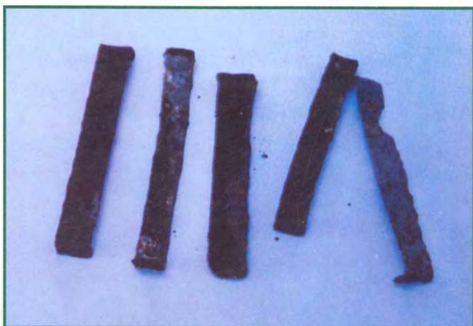
⑥ 1996年维修白塔时发现明代修塔用的铁錡，长17cm宽2cm，厚0.5cm
