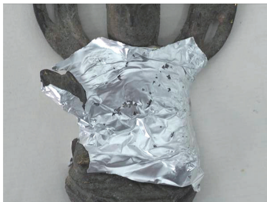
图七 铝箔纸出现腐蚀孔
