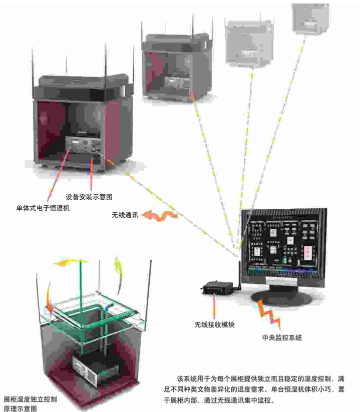
图3 展柜无线湿度控制系统网络结构图
